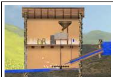
Esquema de funcionamento dos Moinhos de Água
